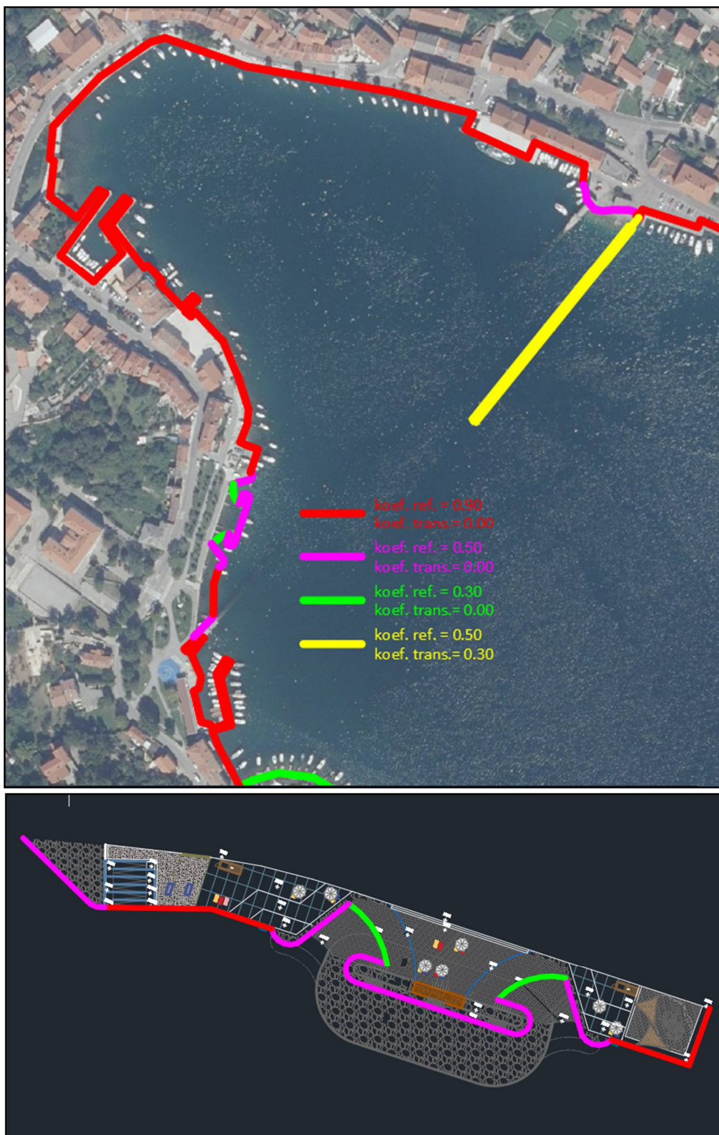
Slika 4.25 Koeficijenti refleksije i transmisije valova numeričkih simulacija projektirane varijante
