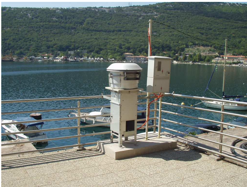
Slika 5.1.: Uzorkivač lebdećih čestica na mjestu uzorkovanja
